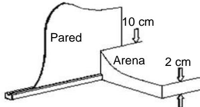
Cubra el suelo preparado de este modo con un fielto geotextil que ascienda de 10 a 12 cm por la pared. Pegue el fielto en algunos puntos de la pared con cinta adhesiva de doble cara. El fielto geotextil evita la aparición de hongos en el liner.
