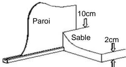
Recouvrez le sol ainsi préparé d'un film géotextile remontant de 10 à 12 cm sur la paroi. Collez le film par endroit sur la paroi avec du scotch double face. Le film géotextile prévient l'apparition de champignons sous le liner.
