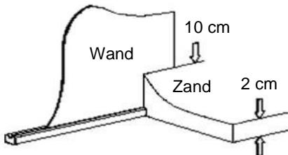
Bedek de op deze wijze voorbereide grond met vilt van geotextiel dat 10 tot 12 cm opstaat tegen de wand. Plak het vilt op enkele plaatsen op de wand met dubbelzijdig plakband. Het vilt van geotextiel voorkomt dat er onder de liner paddenstoelen gaan groeien.
