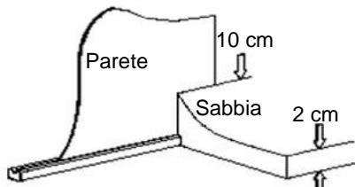
Ricoprite il terreno preparato in questo modo con una pellicola geotessile rialzandola di 10-12 cm sulla parete. Incollate la pellicola protettiva alla parete con scotch biadesivo. La pellicola geotessile previene la comparsa di funghi sotto il liner.
