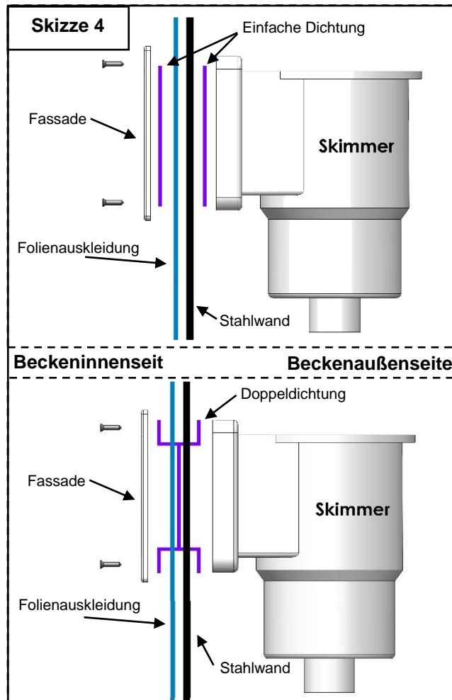
**ACHTUNG:** Ziehen Sie die Schrauben des Skimmers und der Einlaufdüse niemals fest, bevor sich nicht der Wasserstand einige Zentimeter unterhalb des zu montierenden Teils befindet. Die Poolfolie muss durch den Wasserdruk gut gespannt sein.
