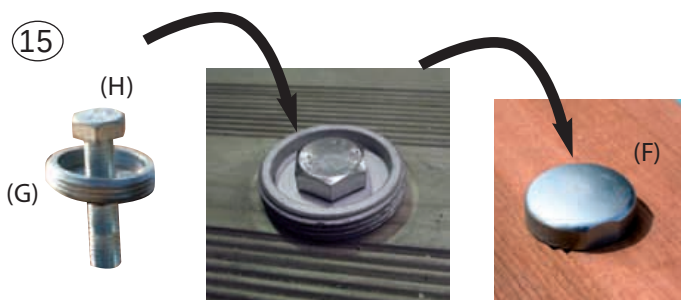
15 Visser fermement les boulons (H) avec l'embase de l'écrou de finition (G). Pour les parties centrales, visser cet ensemble avec chaque douille (I).
