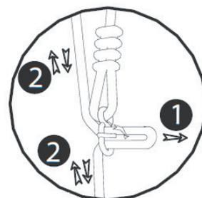
**FR** - Il faut ajuster l'ensemble des cordes pour que le produit soit bien horizontal, à une hauteur comprise entre 35 et 50 cm. Le réglage se fait à l'aide des « 8 de réglage ».
