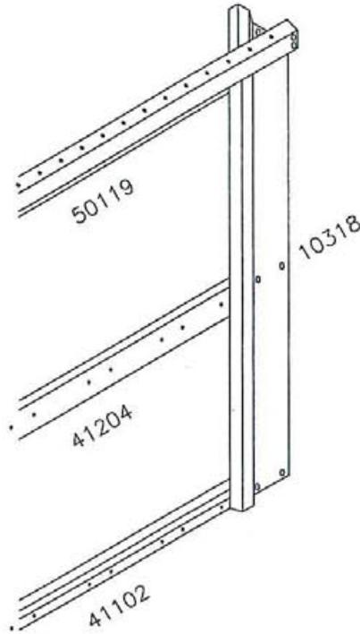
7. FIXER CINQ PANNEAUX MURAUX 10118 EN PARTANT DU PANNEAU D'ANGLE ET EN UTILISANT LA VISSERIE DE LA POCHETTE NO.1 ET LES RONDELLES EN FIBRE DE LA POCHETTE NO.7.
