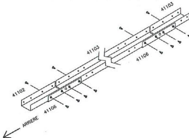
2. FIXER DEUX MONTANTS STANDARDS, 41301 AU CENTRE DE CHAQUE ENTURE RAIL BASE 41106 AVEC DES VIS SAC NO.2, ET LES ECROUS SAC NO. 6.
