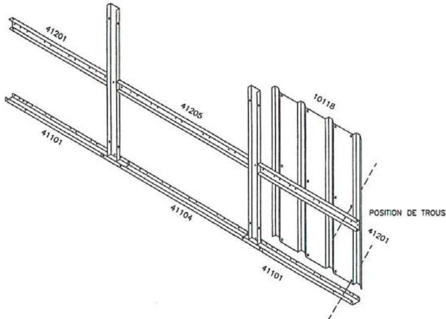
5. LE RECOUVEREMENT DES PANNEAUX 10118 ET 10218 DOIT ETRE FAIT SUIVANT LE SCHEMA CI-DESSOUS, AVEC LES VIS (POCHELLE NO. 1) ET LES RONDELLES EN FIBRE DE LA POCHETTE NO. 7, EN COMMENCANT PAR LE BAS.
