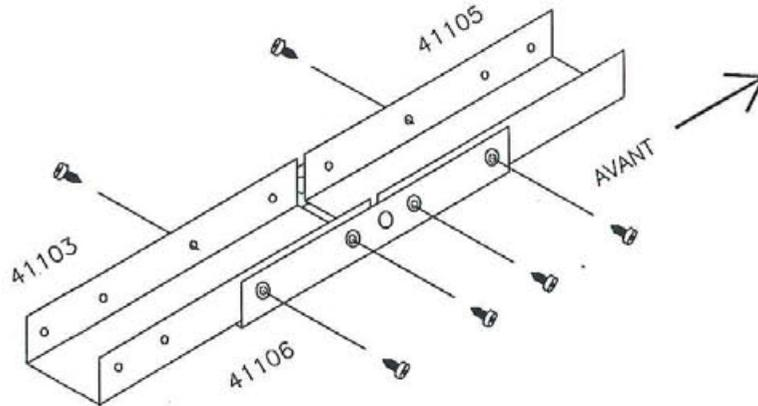
2. FIXER LE MONTANT STANDARD 41301 AU CENTRE DES PROFILS D'ANGLE DE PILIER A L'AIDE DE LA VISSERIE DE LA POCHETTE NO.2, ET LES EROUS DE LA POCHETTE NO.6.
