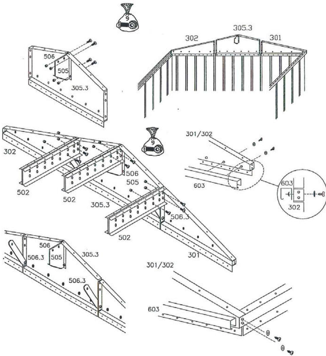
9. FIXER LES EQUERRES DE TOIT AUX POUTRES D'ANGLE RENFORCEES AVEC LES BOULONS DE LA POCHETTE NO. 9
